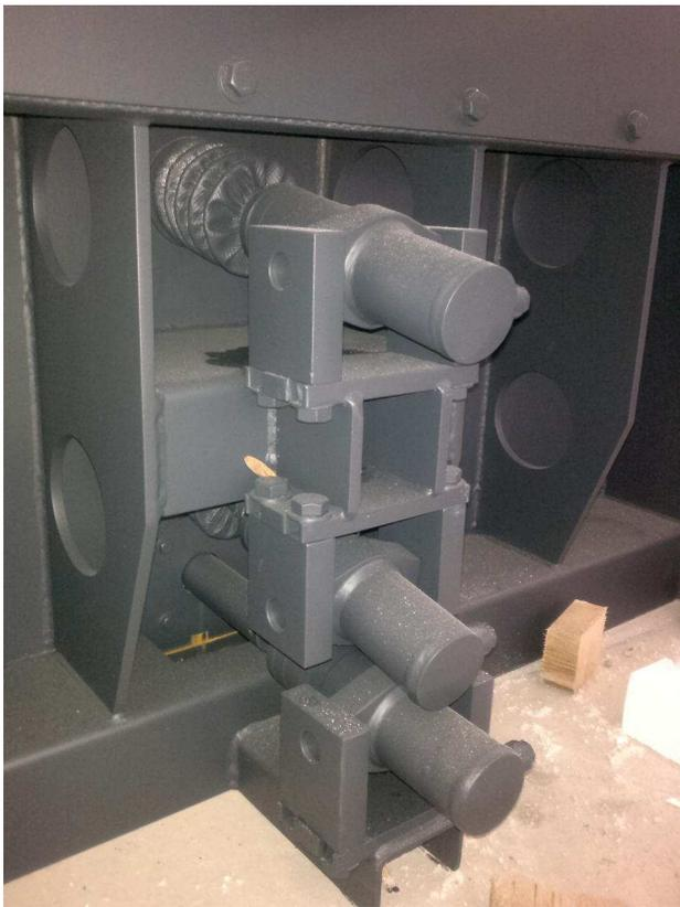
Rispetto alla griglia di alimentazione a gradini, la griglia piana si sviluppa in orizzontale consentendo di risparmiare spazio in altezza. Inoltre si evitano movimenti non controllati del combustibile lungo la griglia, nel senso che è solo la griglia a muovere il combustibile.
