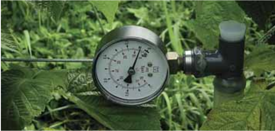
Fig. 3 - Tensiometro a bulbo poroso
