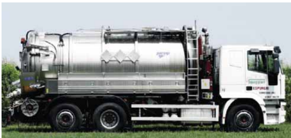
Fig. 13 - Autocisterna da 15 m 3 da adibire al servizio di trasporto del liquame tal quale e del digestato in uscita dal reattore: utilizzabile nel caso di gestioni pluriaziendali anche per rifornire le macchine per la distribuzione in campo
