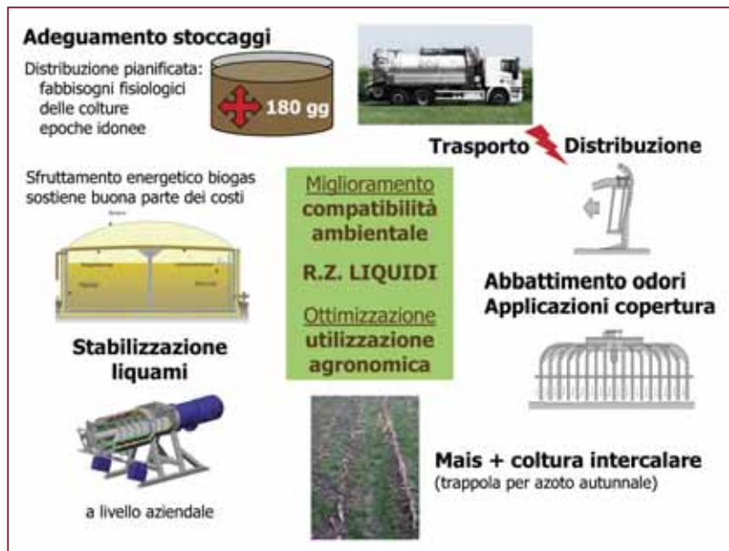
Fig. 33 - Sistema integrato di interventi per migliorare la compatibilità ambientale dei reflui zootecnici
