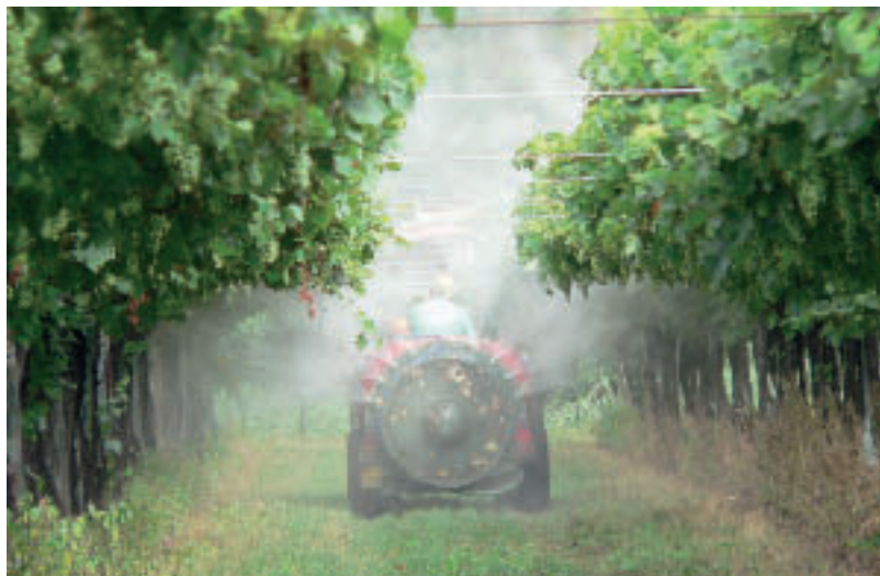
Fig. 99 - Distribuzione di fitofarmaci con atomizzatore
