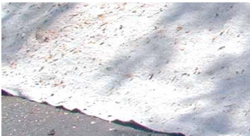
**Foto 4** - Particolare del telo in geotessile
