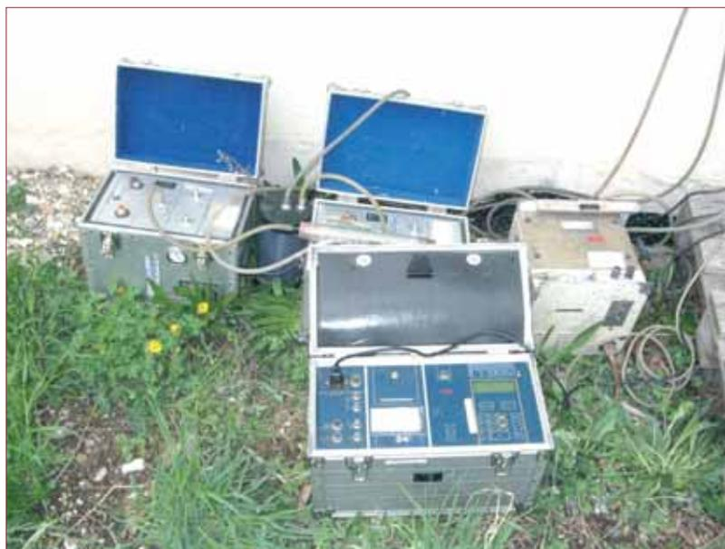
Foto 13 - Attrezzature utilizzate per l'analisi dei fumi.
