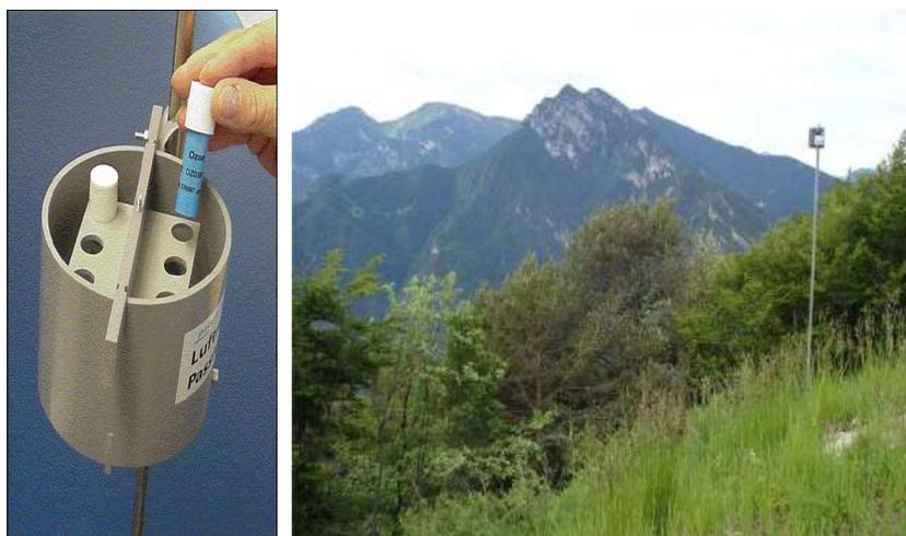
Figura 2. A sinistra: campionario passivo con fiale e supporto (da <http://www.passam.ch/>); a destra: modalità di esposizione in una stazione forestale.
