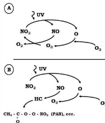
Figura 2. A) Ciclo fotolitico indisturbato del biossido di azoto; B) interazione con gli idrocarburi a formare lo smog fotochimico (da Lorenzini and Nali, 2005).
