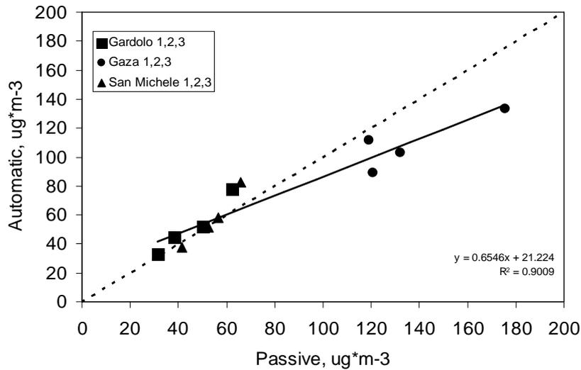
Figura 4. Regressione dei valori medi orari per settimana di  $O_3$  misurati con le centraline automatiche ( $y$ ) contro quelli misurati dai passivi ( $x$ ) (in  $\mu\text{g m}^{-3}$ ) (da Gottardini et al., 2008).
