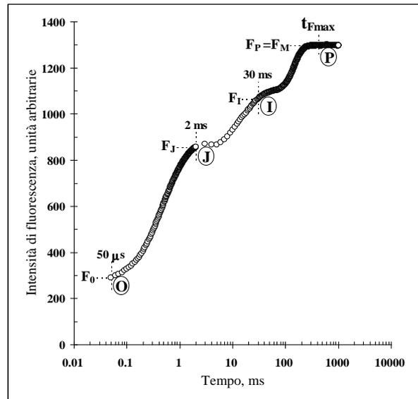
Figura 1. Tipico andamento polifasico del transient di fluorescenza della clorofilla a di piante superiori. Il transiente è rappresentato su scala logaritmica da 50  $\mu$ s a 1 s. I segnali sono le intensità di fluorescenza:  $F_0$  (a 50  $\mu$ s);  $F_J$  (a 2 ms);  $F_I$  (a 30 ms);  $F_P=F_M$  (intensità di fluorescenza massima al tempo  $t_{Fmax}$ ).
