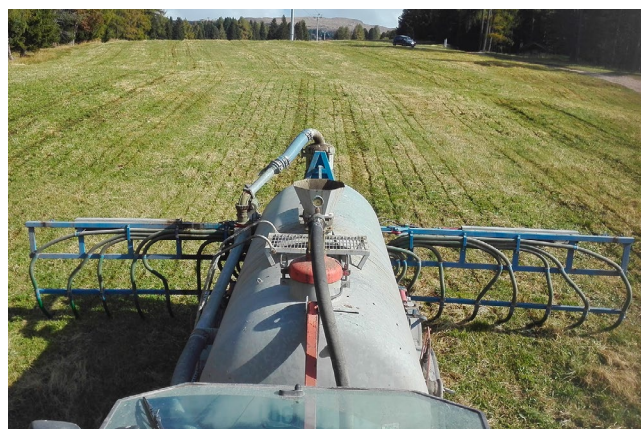
Foto 3. Esempio di sistema di distribuzione a terra del digestato liquido utilizzato dalla Coop. Biodigestore Predazzo.
