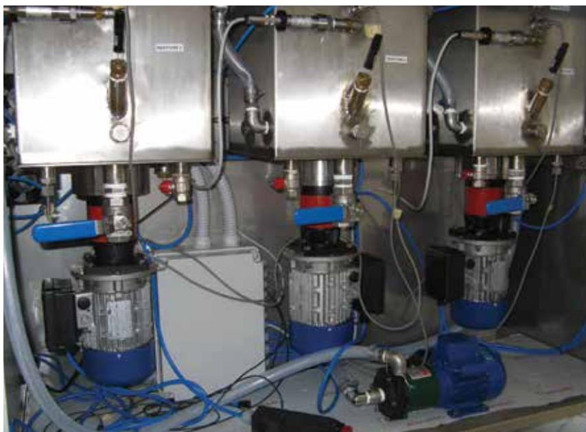
Foto 1 Reattori semi-pilota di laboratorio per l'analisi del processo di digestione anaerobica utilizzati per i test descritti .....
