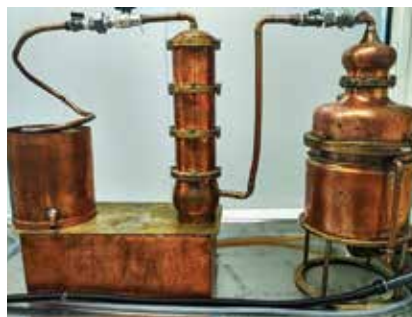
Foto 1 Micro-alambicco a bagnomaria in rame tipo "Tullio Zadra"
