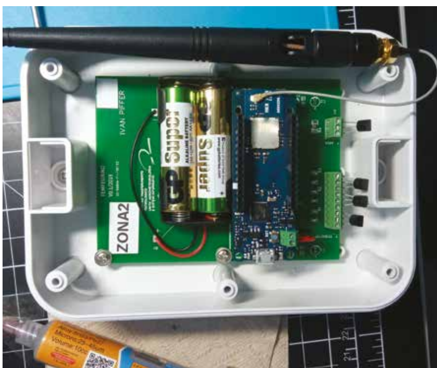
Foto 1 Hardware del dispositivo LoRa
