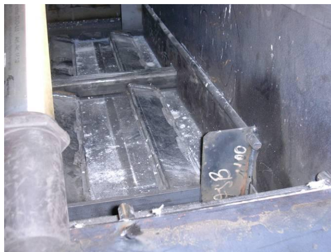
Fig. 4 Asta di spinta della rimozione cenere sotto la griglia
