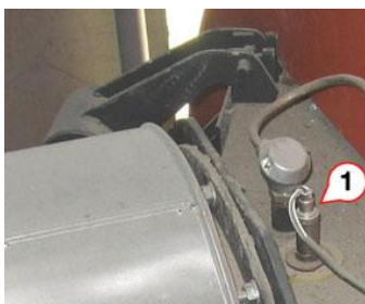
Fig. 7 Sonda O 2
